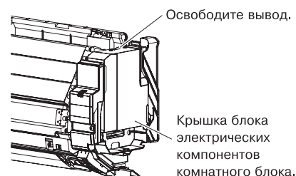
Рисунок 1: Снятие крышки с блока электрических компонентов комнатного блока
