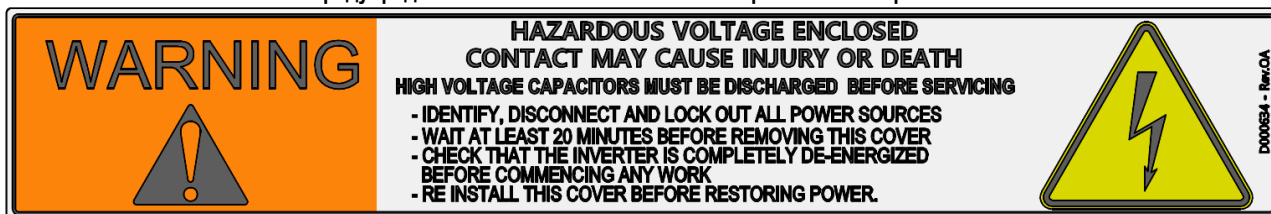
Рис. 14. Предупредительная табличка: Опасность поражения электрическим током!
