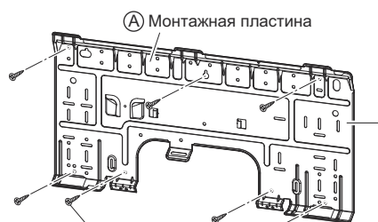
(B) Крепежный винт монтажной пластины (местная поставка: M4 x 25)
