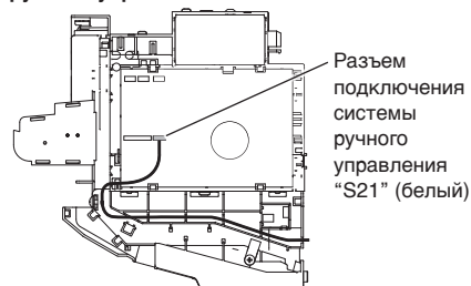
Прокладка соединительного шнура ручного управления
